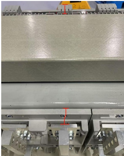
不同电压的电路导体之间爬电距离
