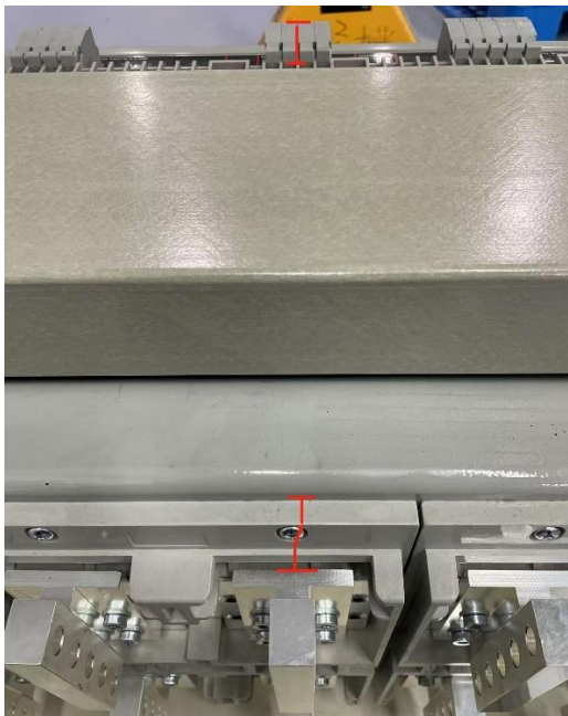
不同电压的电路导体之间爬电距离
