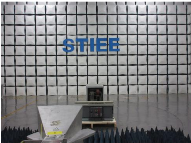
辐射发射（1-6GHz 水平）试验布置
