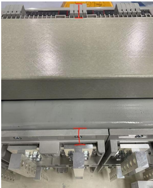
不同电压的电路导体之间电气间隙
